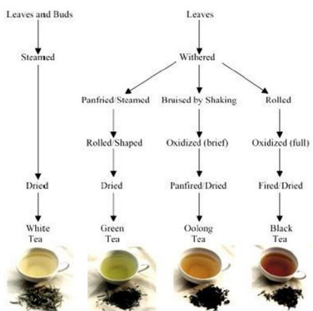
Figura 3 - Processo de obtenção dos chás, mostrando a progressiva oxidação que ocorre a cada etapa de conversão do chá branco para verde, para oolong e, finalmente, para preto (Fonte: SANTANA-RIOS et al. , 2001).
